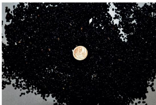
Рис. 3. Мелкая фракция (размер частиц от 1 до 2 мм)
