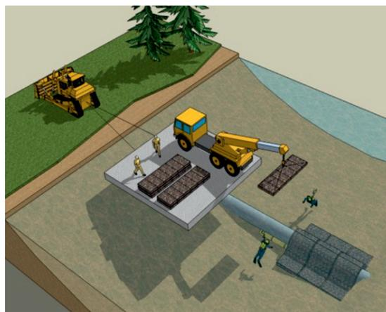
Рис. 3. Балластировка подводного перехода матрацами Рено
