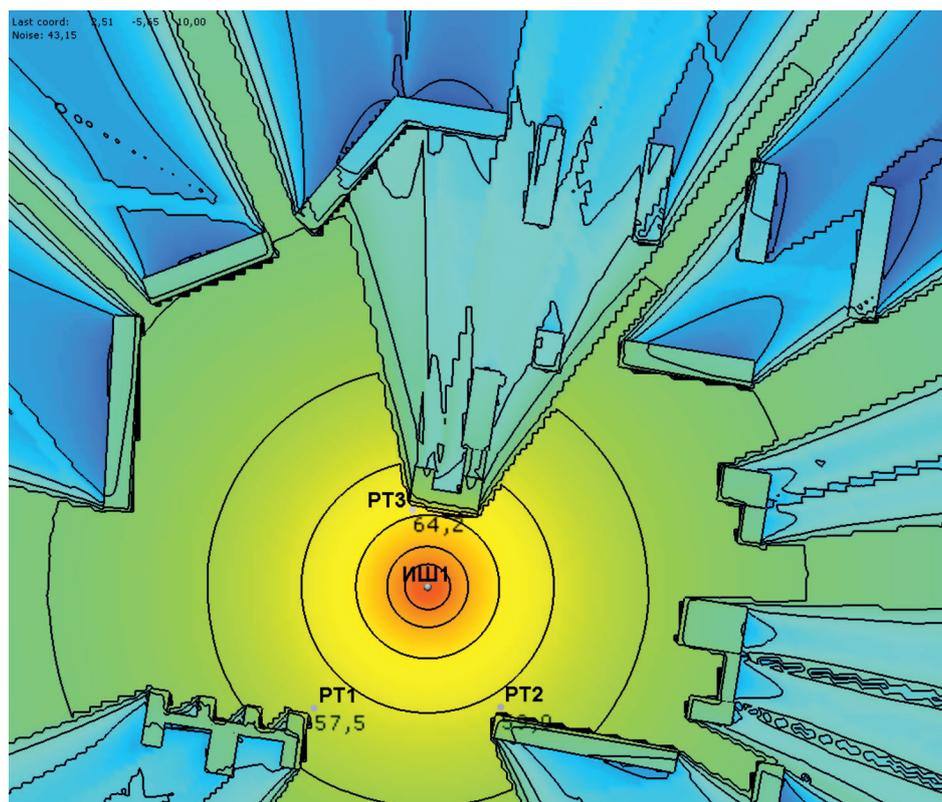
Рис. 2. Оценка шумового режима жилого квартала по эквивалентным уровням звука при выполнении монтажных работ автокраном МАЗ 333702 в дневное время суток (до шумозащиты). Стоянка крана в центре строительной площадки
