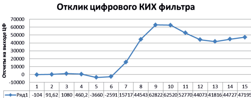
Рис. 3. Отклик позиционного цифрового КИХ фильтра
