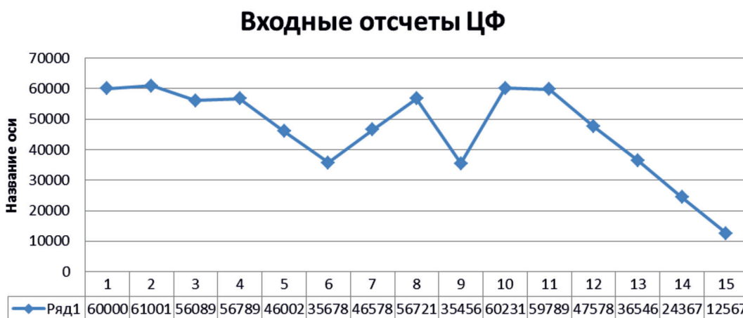
Рис. 2. Входные отсчеты цифрового КИХ фильтра, функционирующего в СОК
