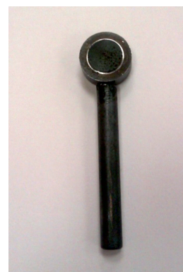
Рис. 2. Образцы для испытаний. 1 – полиамидное покрытие
