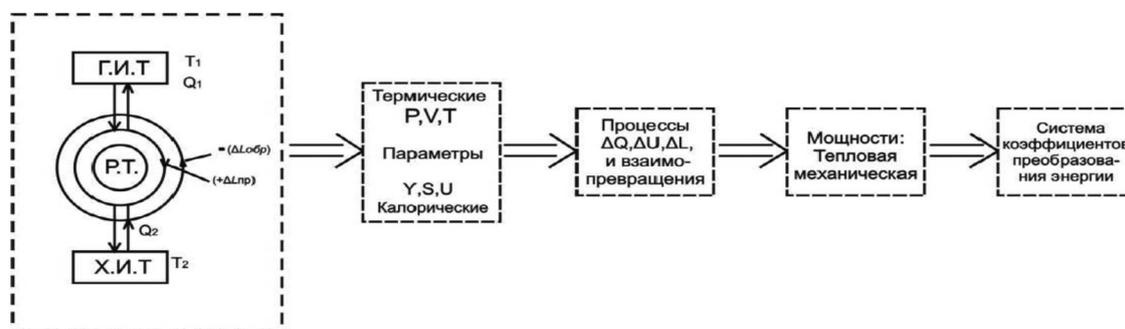
Рис. 1. Равновесное описание последовательности преобразования параметров термодинамической структуры модели полезного использования энергии
