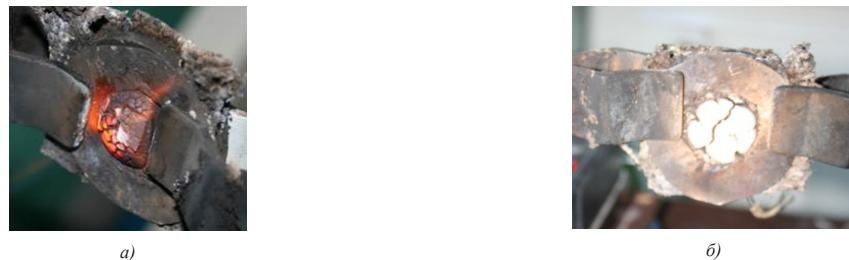
Рисунок 2 – Вид поверхности кокса при воздействии на образец пламени горелки: а) карбид кремния; б) перлит
