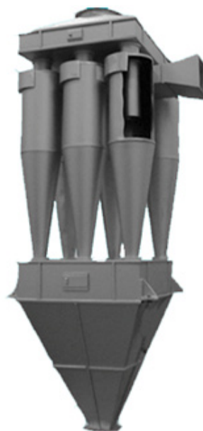
Рис. 1. а) простейший циклонный пылеуловитель (аналог ЦН) б) циклон группового типа СЦН-40-600х6
