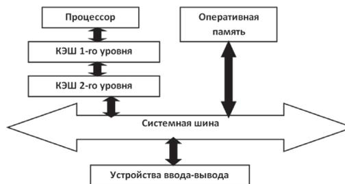
Рис. 1. Схема взаимодействия процессора с энергозависимой памятью
