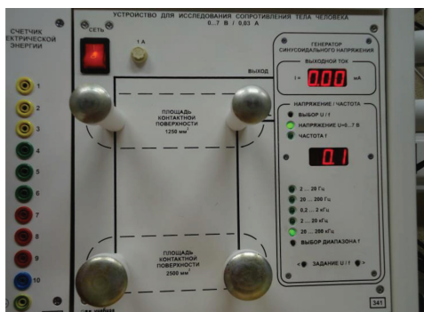
Рис.1. Устройство для исследования сопротивления тела человека
