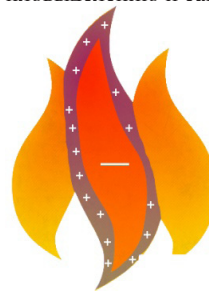
Рис.1 – Ионная структура пламени
