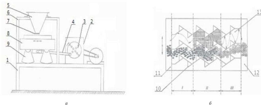
Рис. 1. Экспериментальная установка виброударного сепарирования:
