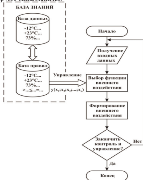
Рисунок – Алгоритм функционирования интеллектуальной системы микроклимата
