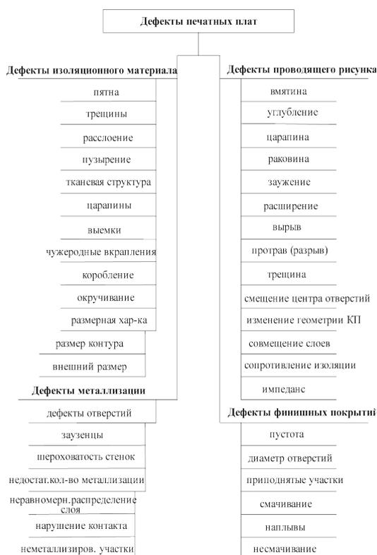
Рисунок 1. Классификация технологических дефектов печатных плат
