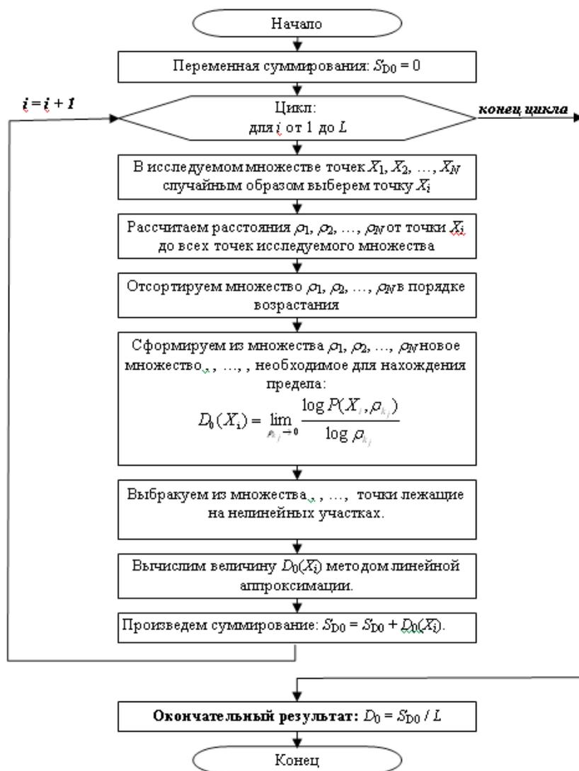
Рис. 1. Блок-схема алгоритма расчета фрактальной размерности Хаусдорфа
