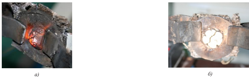
Рисунок 2 – Вид поверхности кокса при воздействии на образец пламени горелки: а) карбид кремния; б) перлит
