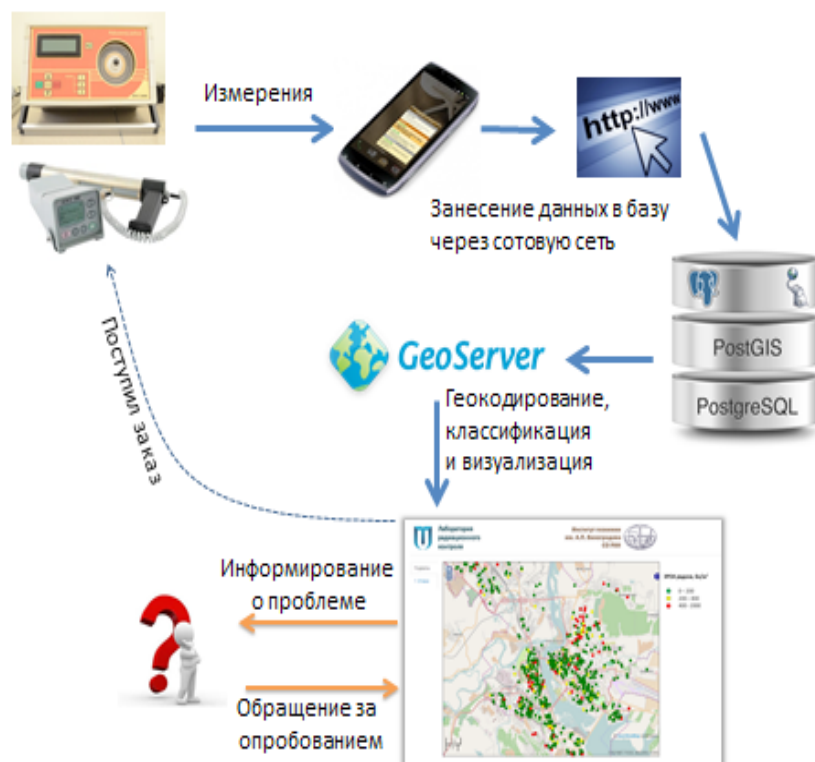
Рисунок 1. Логическая структура системы
