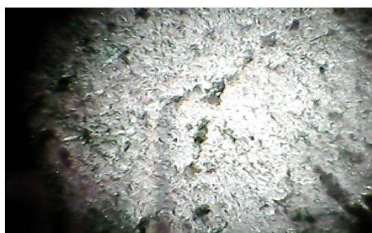
Рис. 2 Микроструктура частично выгоревшего элемента
