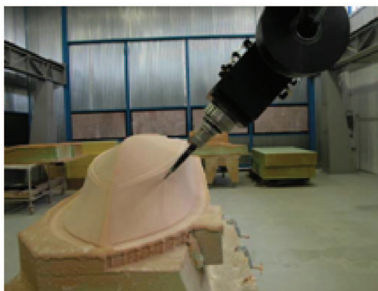
Рис. 1. Пятикоординатный фрезерный станок MR 125, способен обрабатывать детали размером 15х5 м и высотой до 2,5 м
