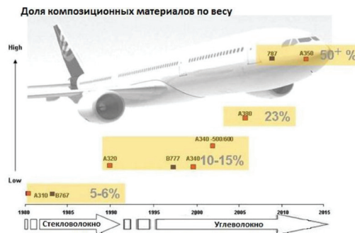
Рис. 2. Содержание композиционных материалов в самолётах компаний Airbus и Boeing
