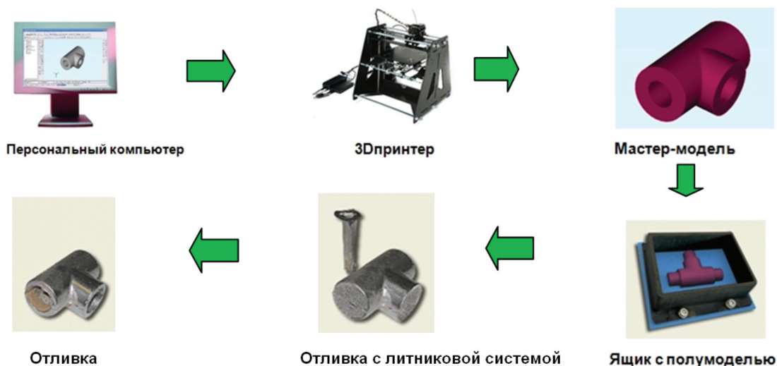
Рис. 2. Технология получения мастер-моделей и отливок
