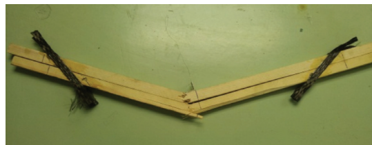
Рис. 2. Образец балочки после испытания
