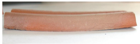
Рис. 3. Дугообразная деформация образцов длиной более 50 мм
