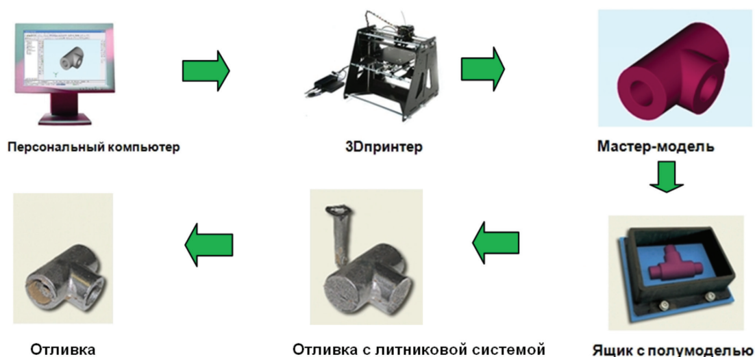
Рис. 2. Технология получения мастер-моделей и отливок
