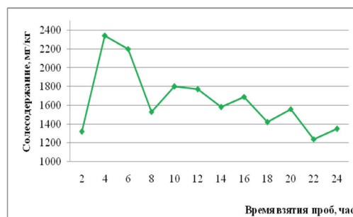
Рис. 2. График изменения солесодержания в левом циклоне котла ОГО-50-1
