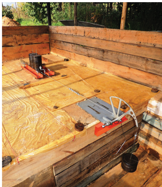
Рис. 5. Общий вид экспериментальной установки во время испытаний модели фундамента из 4-х свай. По обеим сторонам свайного фундамента расположены неподвижные боковые опоры направляющие с линейными подшипниками, препятствующие боковому смещению свай из вертикальной плоскости
