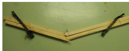
Рис. 2. Образец балочки после испытания
