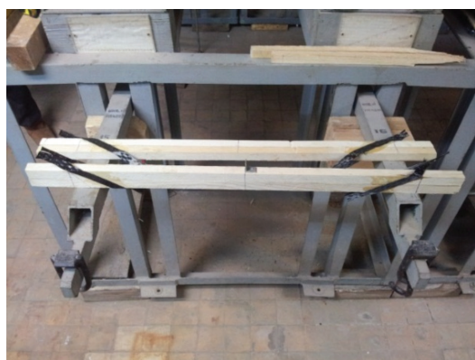
Рис. 1. Образцы балочек до испытания
