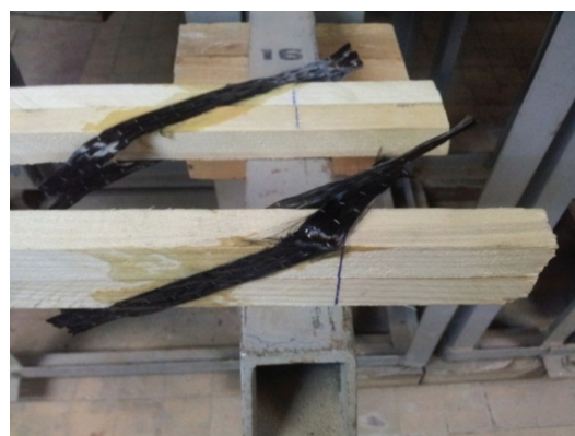
Рис. 1. Образцы балочек до испытания
