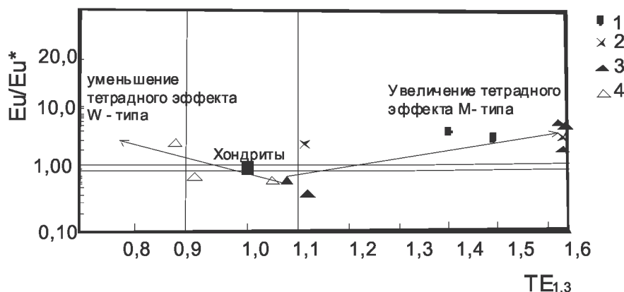
Рис. 1. Диаграмма Eu/Eu^* - TE_{1,3} для породных типов карбонатитового комплекса эдельвейс: 1 – флогопитовые пироксениты, 2 – сиениты, 3 – кальцитовые карбонатиты, 4 – доломитовые карбонатиты
