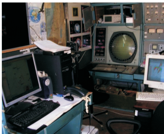
Рис. 10. Радиолокатор МРЛ5 (вид внутри приёмно передающей кабины)
