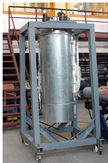
Рис. 1. Внешний вид каупера аэродинамической трубы
