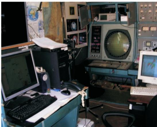
Рис. 10. Радиолокатор МРЛ5 (вид внутри приёмно передающей кабины)
