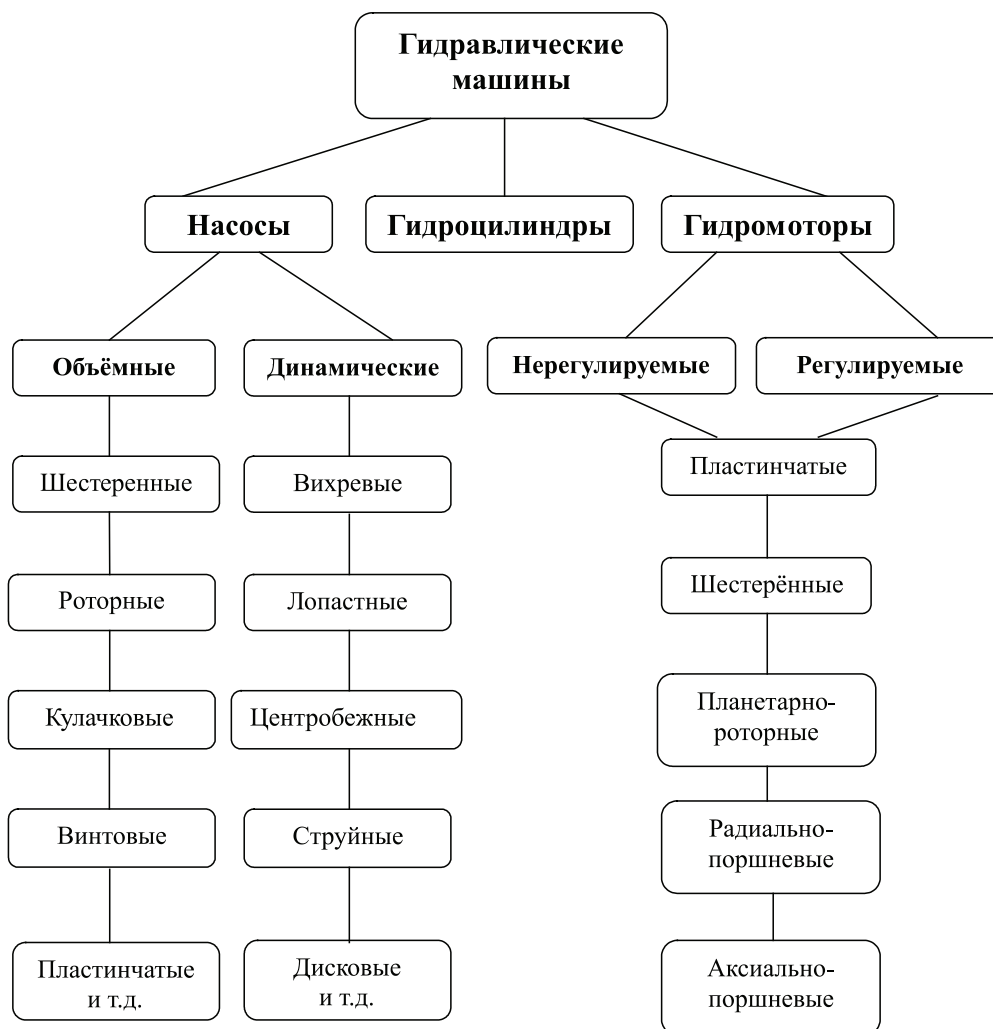
Рис. 1. Схема классификаций гидравлических машин
