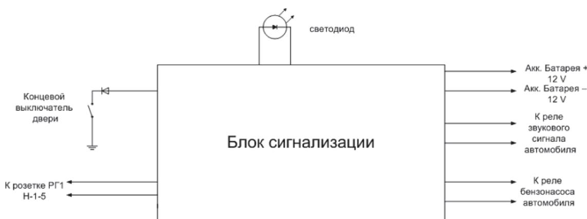
Рис. 1. Схема подключения автомобильной сигнализации
