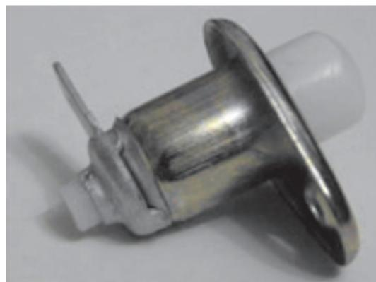
Рис. 5. Концевой выключатель двери автомобиля
