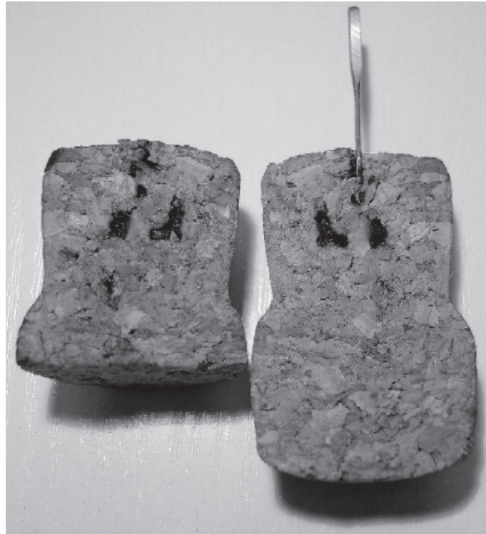
Рис. 1. Термическое разрушение пробки в процессе образования шарового разряда на металлической игле
