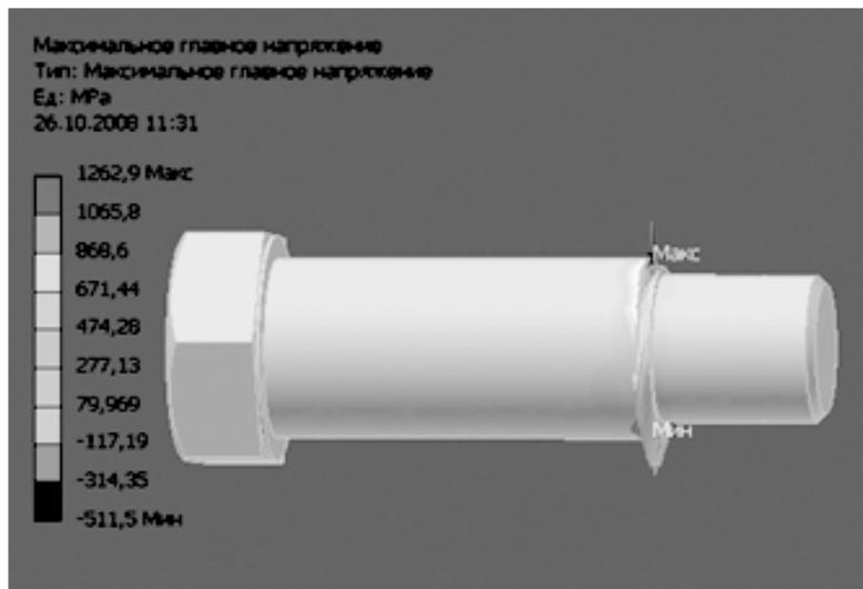
Конструкция и палитра максимального главного напряжения срезного пальца
