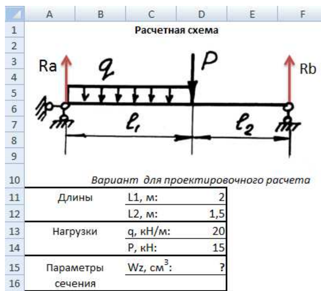
Рис. 1. Исходные данные для проектировочного расчета балки
