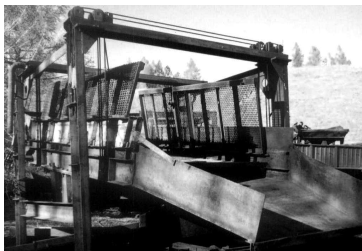
Рис. 2 Механический лотковый шлюз
