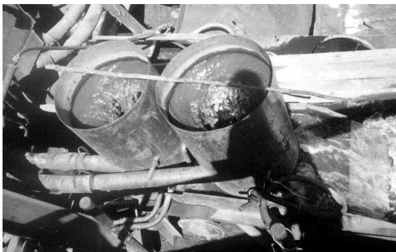
Рис. 2 Гидромеханические колонны для извлечения мелкого золота
