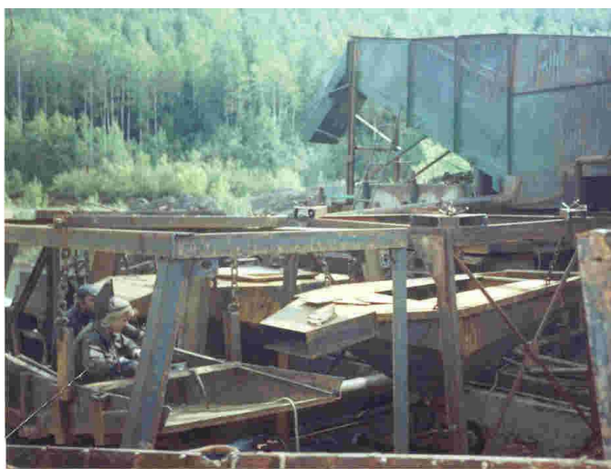
Фото 1. Обогатительный комплекс для гравитационного обогащения минерального сырья
