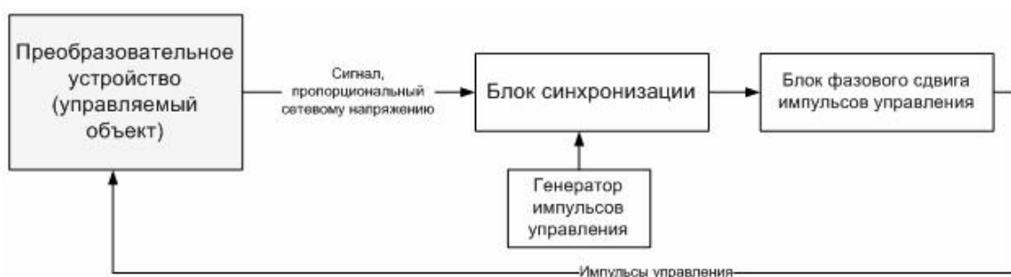
Рис. 1. Схема работы системы управления регулятором напряжения
