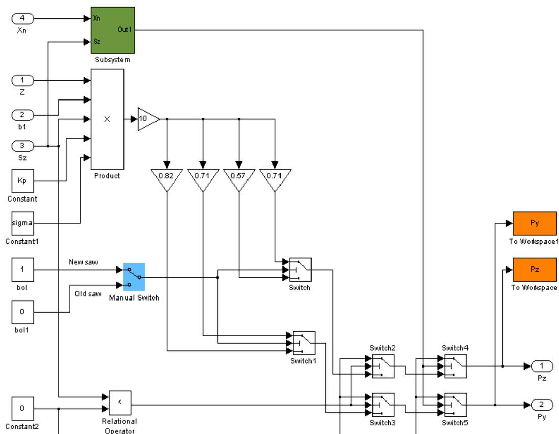
Рис. 2. Структурная схема алгоритма процедурного блока SUBSYSTEM
