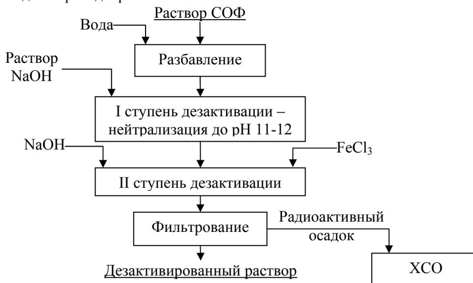
**Рис.3.** Технология переработки, обезвреживания и дезактивации радиоактивных хлоридных растворов от гидроразмыва расплава СОФ.
