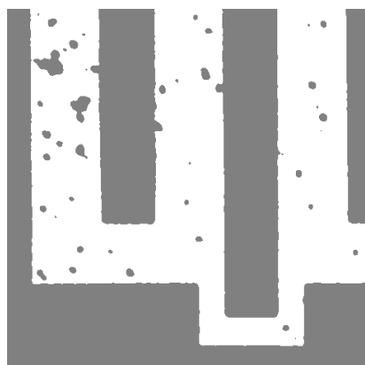
Рис. 2. Фрагмент резистивного слоя (толщина плёнки около 300 нм), полученного методом термического испарения навесок кермета КС-20С в вакууме на поверхности поликорковой подложки, толщина плёнки около 300 нм
