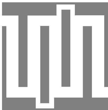
Рис. 2. Фрагмент резистивного слоя (белый цвет) чип-резистора меандрового типа (показаны две подгоночные перемычки)
