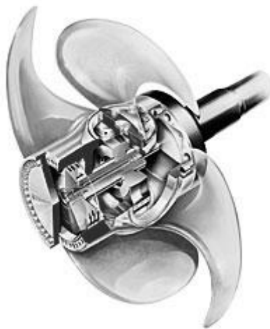
Рис. 1 – Вид гребного винта с поворачивающимися лопастями
