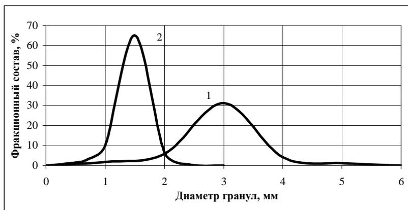
**Рисунок 1.** Дифференциальные кривые распределения гранул быстрорастворимого киселя по размерам: 1 – гранулирование без активатора; 2 – гранулирование с активатором
