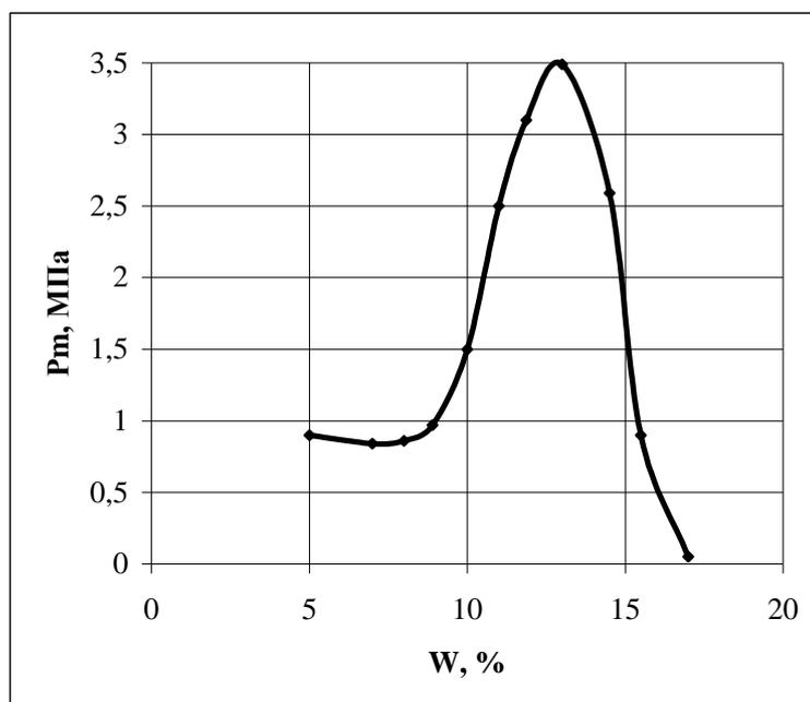
**Рисунок 1.** Зависимость пластической прочности дисперсной смеси для гранулирования черничного киселя от влажности
